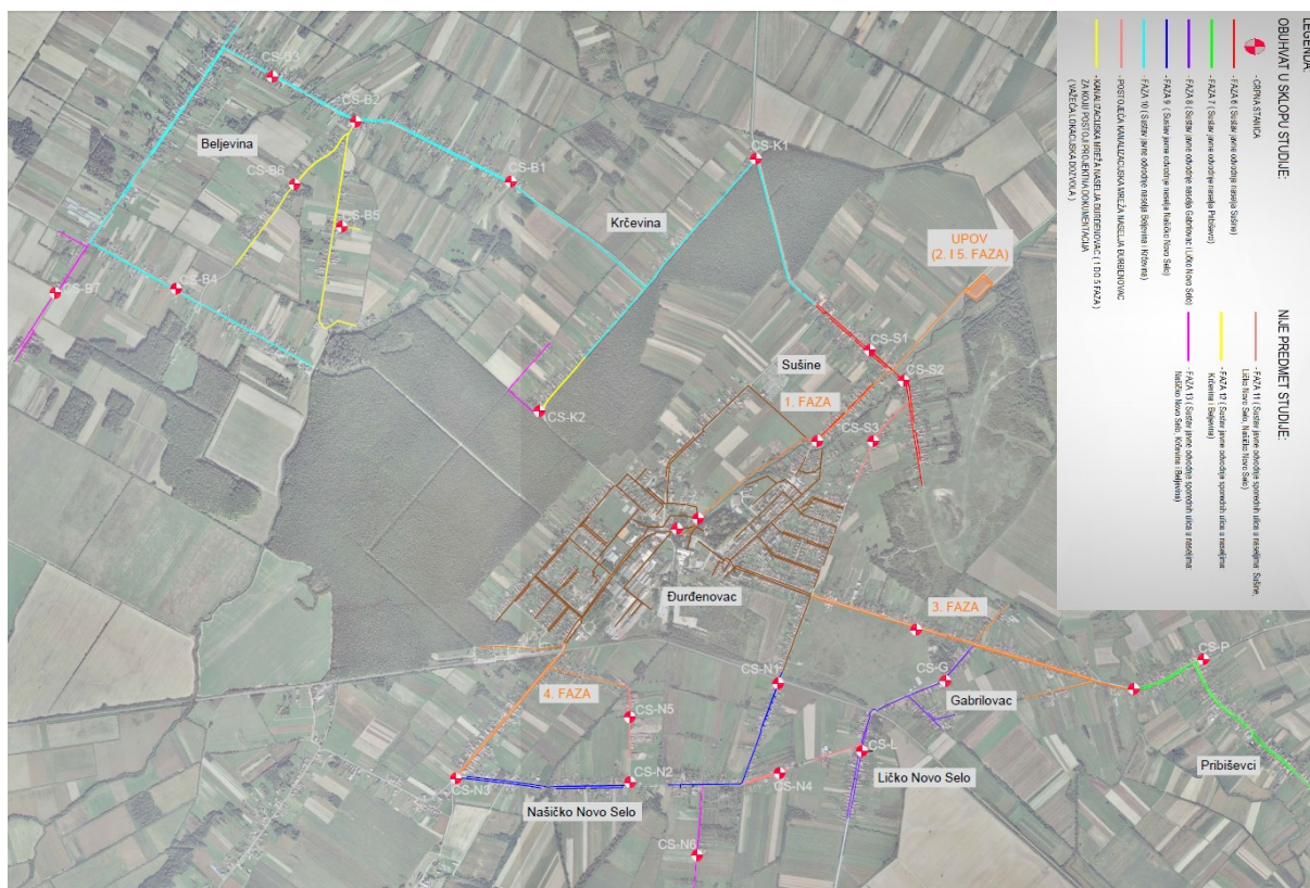
Slika 2-2 Usvojen prikaz sustav odvodnje Općine Đurđenovac
